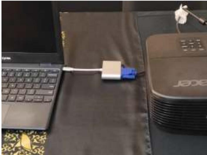
Gambar 46. Pemasangan Port VGA Proyektor ke Port VGA melalui Konektor
