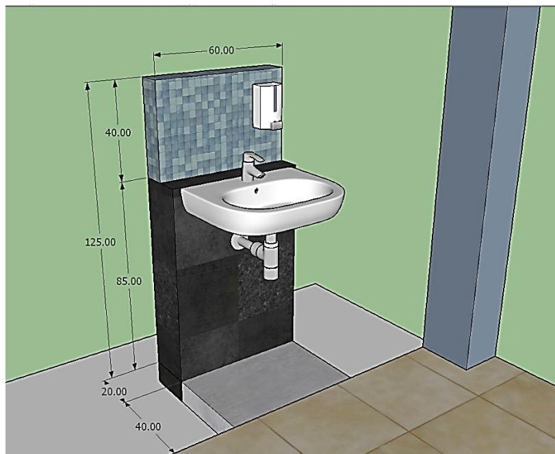
Gambar 15. Contoh Desain dan dimensi tempat cuci tangan
